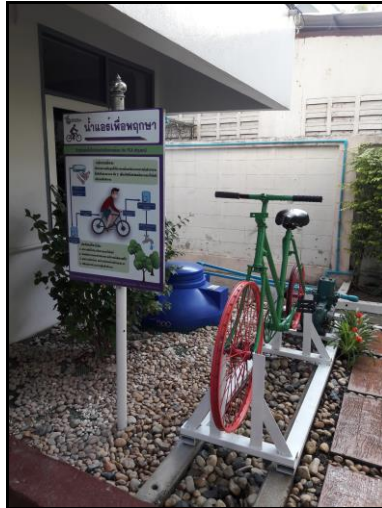
ภาพที่ 4-6 การรองรับน้ำจากเครื่องปรับอากาศมาใช้รดน้ำต้นไม้ภายใน สำนักงานการไฟฟ้าส่วนภูมิภาคจังหวัดปทุมธานี
